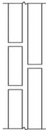
الشكل 7-4/8: أنواع المفاصل للألواح العازلة الجاسئة المستعملة في الجدران [5]
